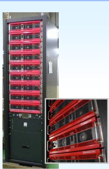
図4 高電圧直流給電用整流装置 プロトタイプ試作機(Bタイプ) N+1ユニット冗長方式 100kW定格出力
