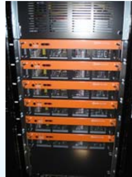
図5 電圧補償装置プロトタイプ試作機 N+1ユニット冗長方式 100kW定格出力
